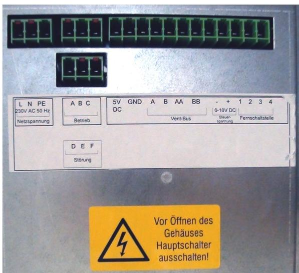
Elektro-Anschlusskasten im Auslieferungszustand
